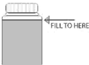
**DO NOT SET THE CAP DOWN OR TOUCH THE INSIDE OF THE CAP OR BOTTLE. FILL THE SAMPLE BOTTLE TO THE MARKED LINE ON SHOULDER WITHOUT RINSING OR OVERFILLING.**
